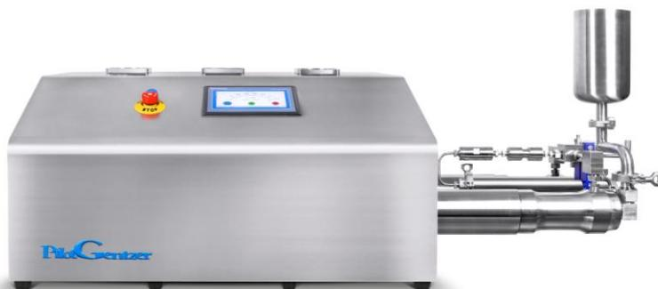
パイロット版ジナイザーはナノ材料開発を支援するパイロットスケールの液体プロセス装置です。これは製品ラインアップにマイクロ流体**ダイヤモンド均質化チャンバー**を利用し、そのマイクロチャンネル内で流体に高いせん断力と強い衝撃を与え、粒子径の縮小と細胞の破壊という最終目標を達成することができます。ナノ分散液、ナノエマルジョン、ナノチューブ、グラフェン、リポソーム、固体分散液、懸濁液の研究開発および小規模生産に使用できます。また、媒体に触れる部分はすべて、316L ステンレス鋼、17-4ph ステンレス鋼、チタン合金、タングステンカーバイド、PTFF、UHMWPH などの FDA 認定の安全な材料を使用しています。
